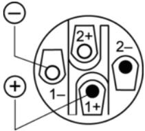
Die nebenstehende Abbildung zeigt die Belegung der verriegelbaren NL4-Einbausteckverbinder.
